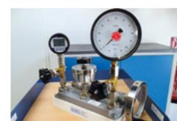
Spindelpresse mit Drucksensoren zur Prüfung
