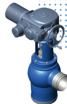
Wasserregelventile werden im Kraftwerk in vielfältiger Bauweise gefordert. Unsere Hochdruckregelventile wie das Anfahrregelventil, das Wasserregelventil sowie die Ablaufregelventile werden aus blockgeschmiedeten Materialien hergestellt. Die Kundenforderung bestimmt dabei Bauform und Abmessungen. Entsprechend der Aufgabenstellung werden Druckabbau und Durchsatzmenge über geregelte Stufen reduziert und auf die geforderten Betriebsverhältnisse eingestellt.
