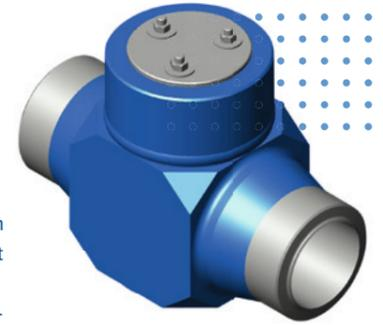
Hochdruckabsperrklappe mit selbstdichtendem Deckelverschluss in kompakter Bauweise. Der Klappenteller mit Klappenhebel ist frei beweglich aufgehängt. Negative Beeinträchtigung durch das Medium wird damit ausgeschlossen. Die revisionsfreundliche Bauweise reduziert Revisionskosten. Der lichte Sitzdurchmesser gleicht nahezu der lichten Nennweite, damit werden Strömungsverluste vermieden. Der strömungsabhängige Wirkungsgrad bleibt erhalten.
