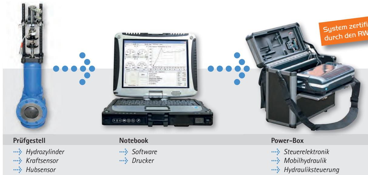
Ein Ausbau des Ventils oder eine Erhöhung des Betriebsdrucks ist bei dem Einsatz dieses Verfahrens nicht notwendig!
